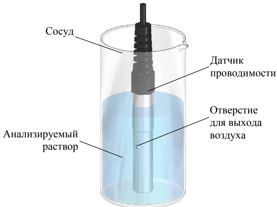
Рисунок 2.3 – Проведение измерений погружным методом
